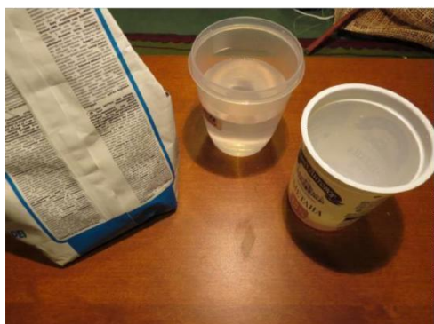
Разводим строительный гипс водой до консистенции сметаны
